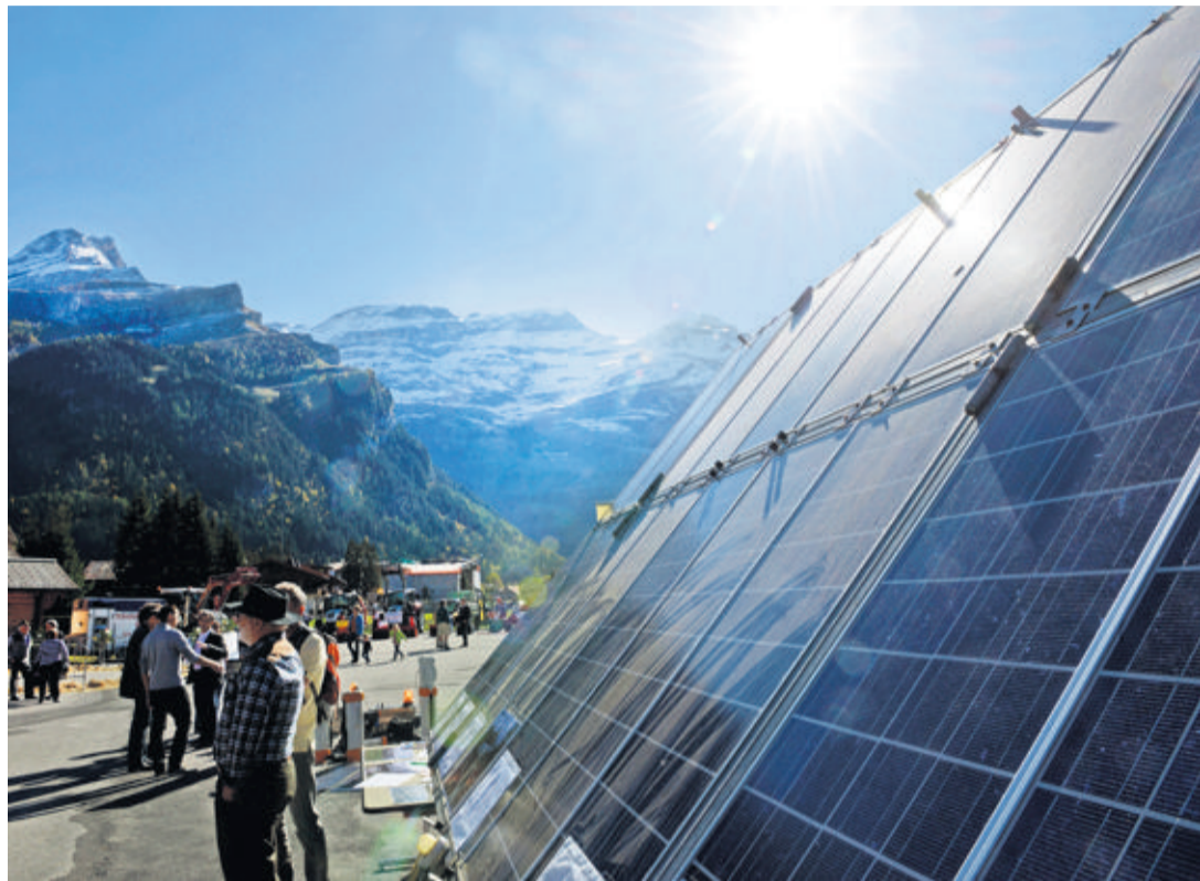
La technologie pour exploiter les énergies douces en montagne existe. Ici, des panneaux solaires montés sur une remorque permettant d'alimenter une machine à traire. PHILIPPE MAEDER
